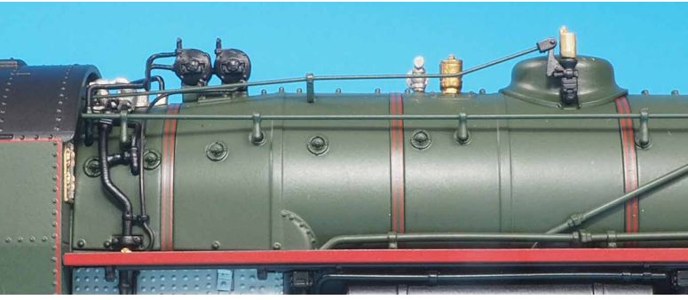
Die komplette Zugmechanik der Dampfpfeife.
