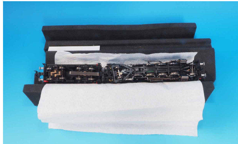
Legt man das Fahrzeug auf Küchenpapier, kann es damit nach der Wartung aus der Lokliege gehoben werden.
