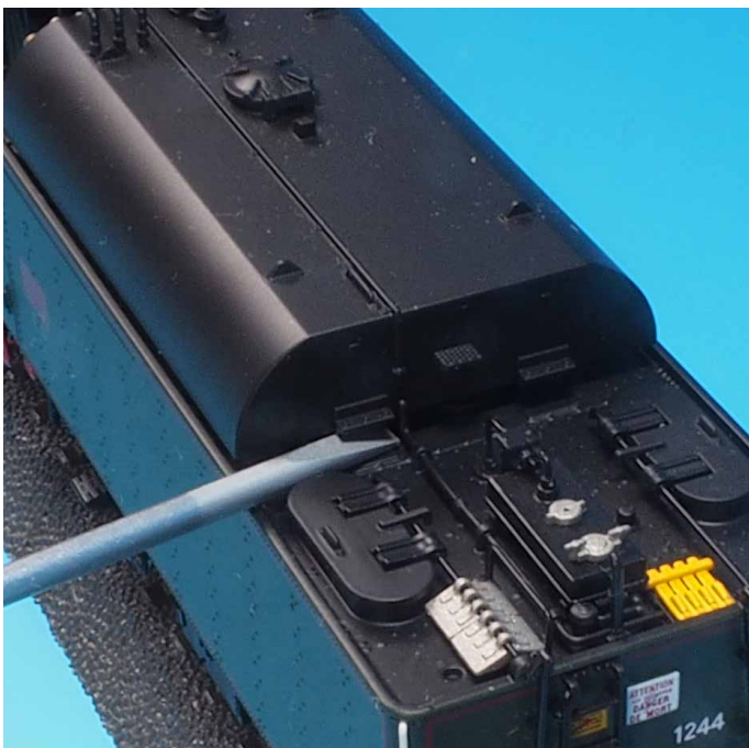
Die Abdeckung hebt man hinten etwas an, um sie zu lösen.
