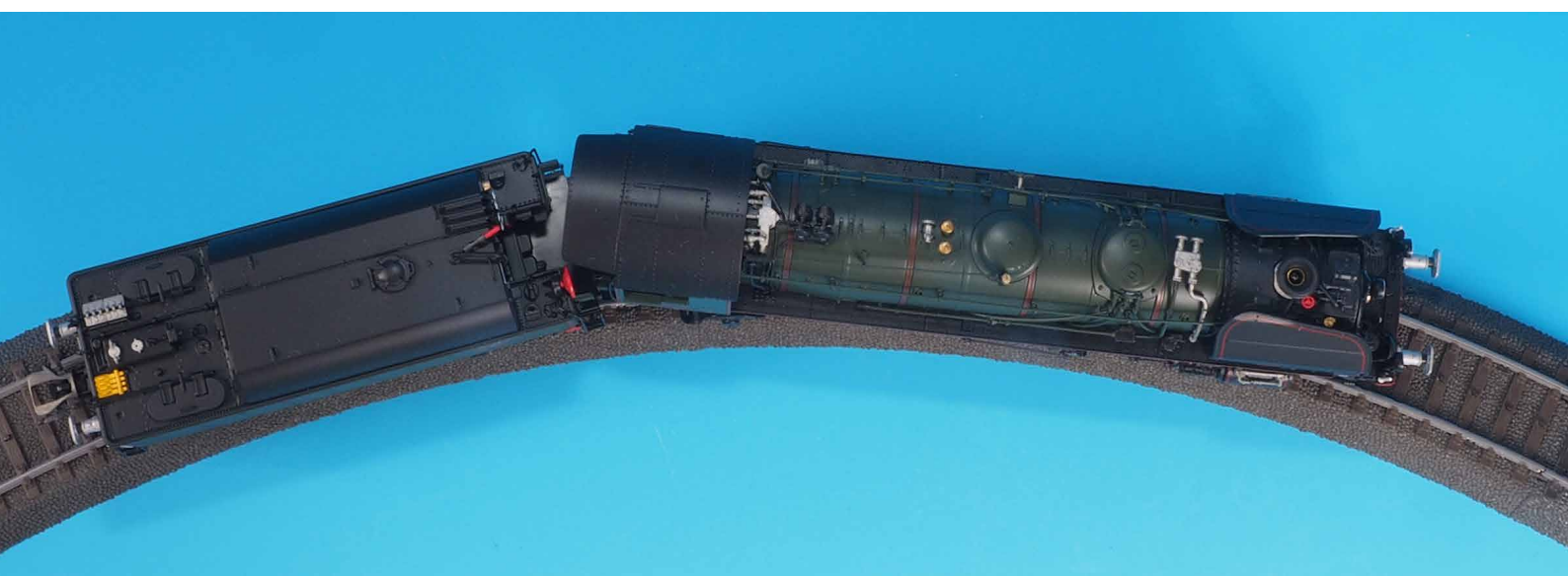
In der Kurve schwenkt die Lok besonders im Bereich des Führerhauses aus.
