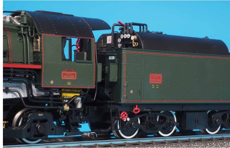
Die Armaturen auf der Tenderseite.
