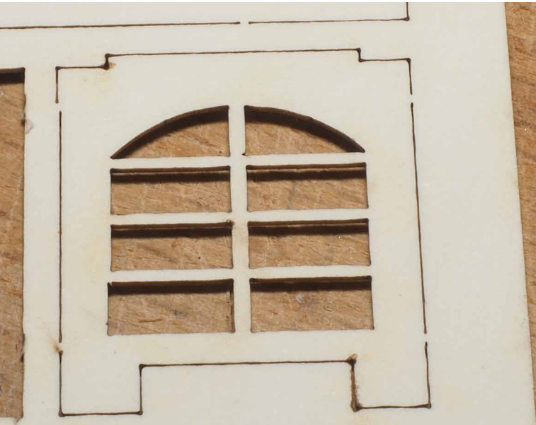
Ein Fensterelement des oberen Aufbaus wird durch vier Stege gehalten, die durchtrennt werden müssen.
