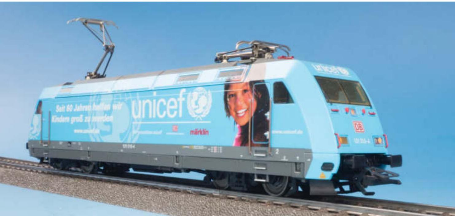
Die Unicef 101 hat den alten Antrieb, aber bereits einen mfx-Decoder mit einem Extra-Soundmodul und gelben LEDs.
