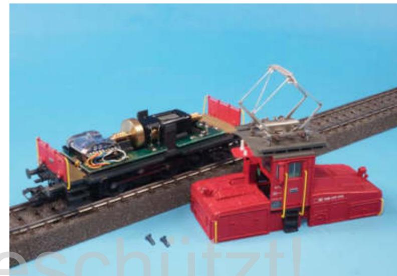
Das Gehäuse besteht aus zwei Teilen. Die Vorbauten sind geklickt und werden vom Führerhaus gehalten.
