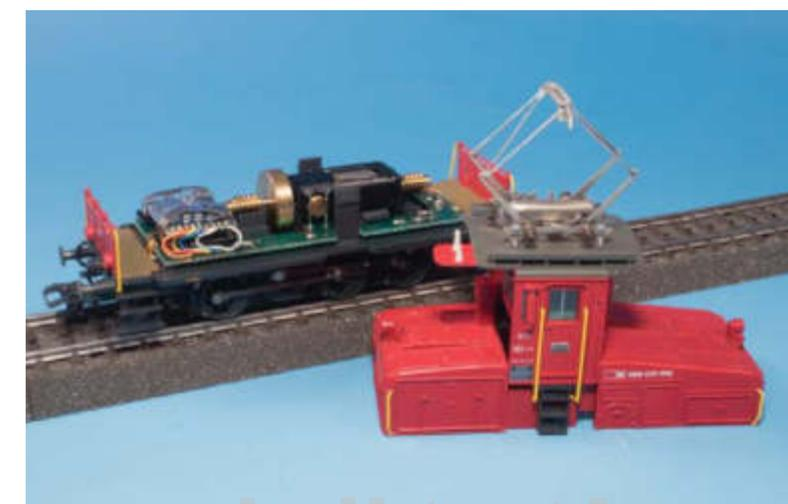
Bei der 36330, einem Modell der SBB Ee 3/3 wurde ab Werk ein einfacher Decoder im Schrumpfschlauch ohne Schnittstelle verbaut. Diesen zu tauschen, ist aus Platzgründen schon nicht ganz einfach.
