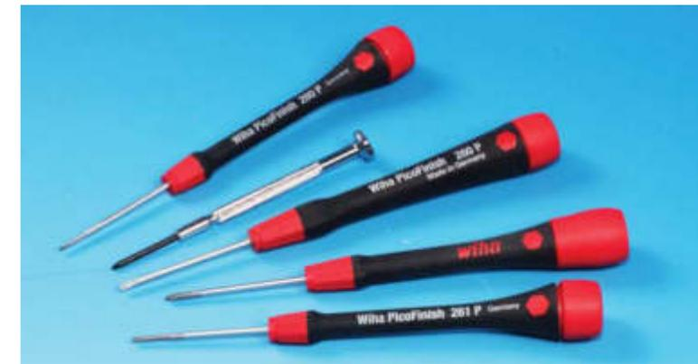
Die Wiha-Schraubendreher haben zum Beispiel einen deutlich längeren Schaft als die aus dem Werkzeugset von Märklin. Damit kommt man besser an versteckte und tief liegende Schrauben.
