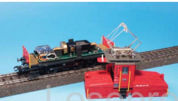
Die Ee 3/3 der SBB mit Mittelmotor und sichtbaren Schnecken auf der Motorwelle. Am Motor sieht man einen runden kupfernen Punkt, dahinter verbergen sich die Kohlebrüsten der DC-Motore.
