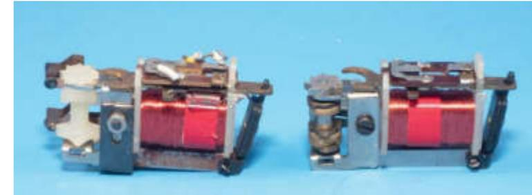
Zwei Umschalter mit Zahnwalzen und Schalter auf der Oberseite des Umschaltrelais.
