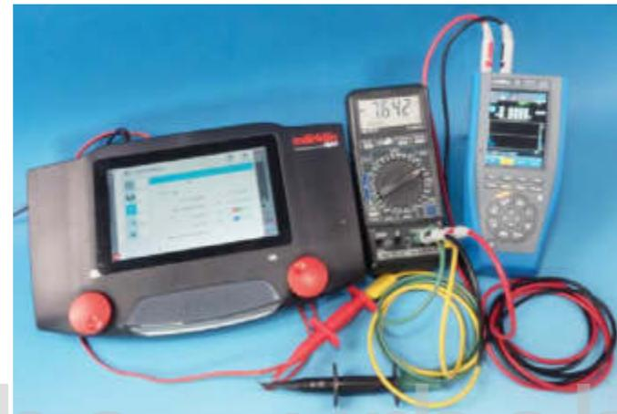
Die CS zeigt im Display 19,3 Volt an, die zwei Messgeräte zeigen im DC-Betrieb lediglich etwas um die 7 Volt an. Links ein ganz einfaches etwa 20 Jahre altes Multimeter. Rechtes das Metrix 3293, es springt so stark im Wert hin und her, dass der Wert im Bild nicht ablesbar ist.
