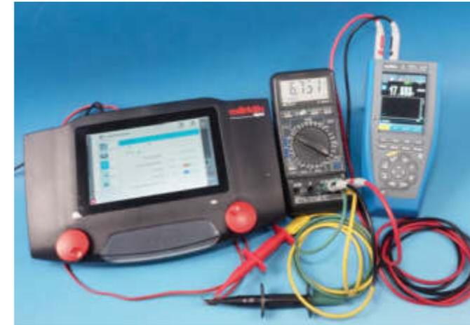
Der gleiche Messaufbau, aber nun stehen die Messgeräte im AC-Betrieb. Das Metrix zeigt nun einen konstanten Wert an und liegt mit etwa 17Volt schon viel dichter an dem Wert der CS.
